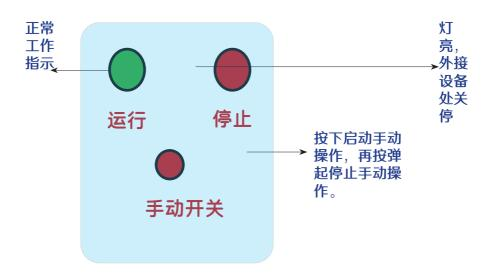
控制板从 RS485 总线上接受报警系统的控制信息,通过设置可关联与本设备联动的探头号,方便分区联动控制。
